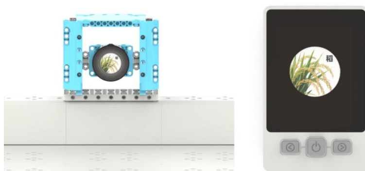
图 14 作物辨识装置显示作物标识及机器人控制器屏幕显示作物标识的示意图
